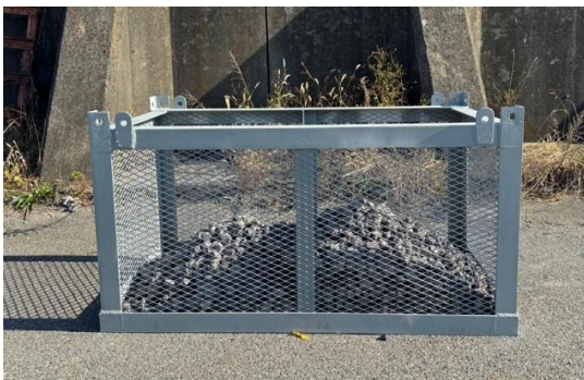
図2：鉄鋼スラグをケージに入れ、 海中に沈めた
